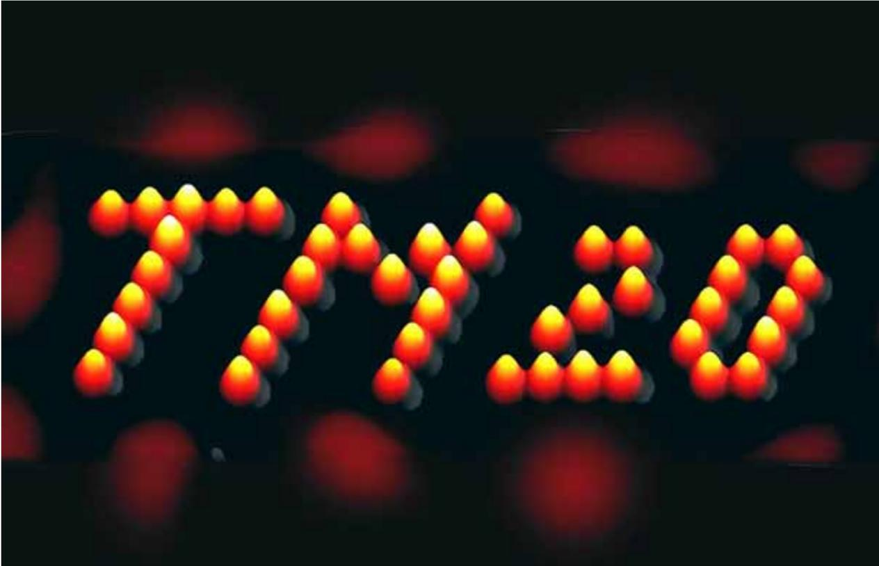
Con una precisión de milésimas de nanómetro, y en seis horas de paciente trabajo, los investigadores del INA han construido, átomo a átomo, el logotipo del veinte aniversario de Tercer Milenio. Cuarenta y cuatro átomos de cobalto sobre una superficie de plata en 15 nanómetros. INA
